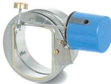
*Motorsteuerung (rechts montiert), öffnet in den Betriebspausen die Regelscheibe, somit wird der Schornstein gelüftet und dient dem Brenner somit als Starthilfe.*
