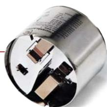
**Thermisch gesteuerte Abgasklappe für Gasfeuerstätten** Die Ausführung mit zwei durch Bimetall bewegten Klappen eignet sich für wandhängende und Standardgeräte.
