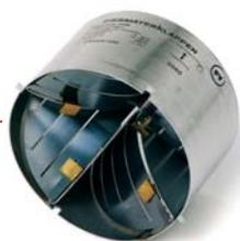
**Thermisch gesteuerte Abgasklappe für Gasfeuerstätten** Die Ausführung mit vier Lamellen aus Bimetall eignet sich für kleine und Sondergeräte.
