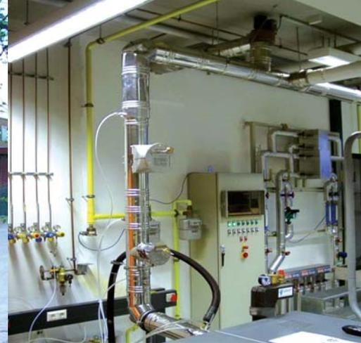
Prüflabor für Zugbegrenzer und Abgasklappen.
