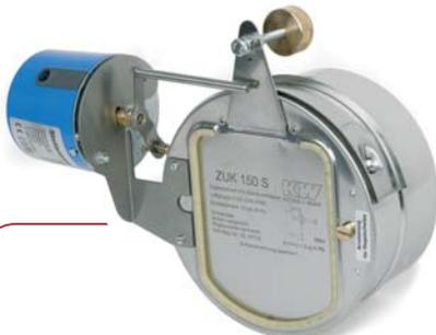
*Motorsteuerung (links montiert), schließt die Regelscheibe in den Stillstandszeiten der Feuerstätte und verhindert somit eine ungewollte Auskühlung des Aufstellraumes.*
