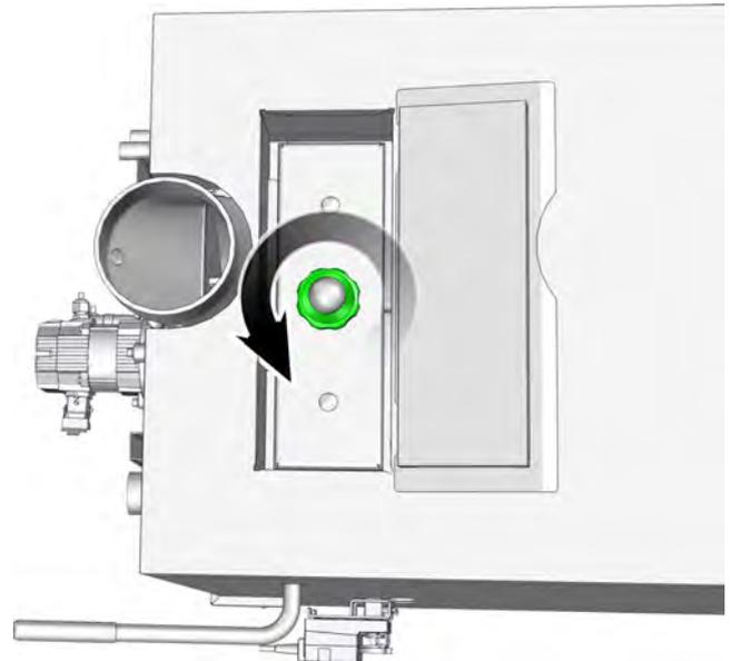
Den Kugelgriff um 180° drehen und den Wärmetauscherdeckel abnehmen.
