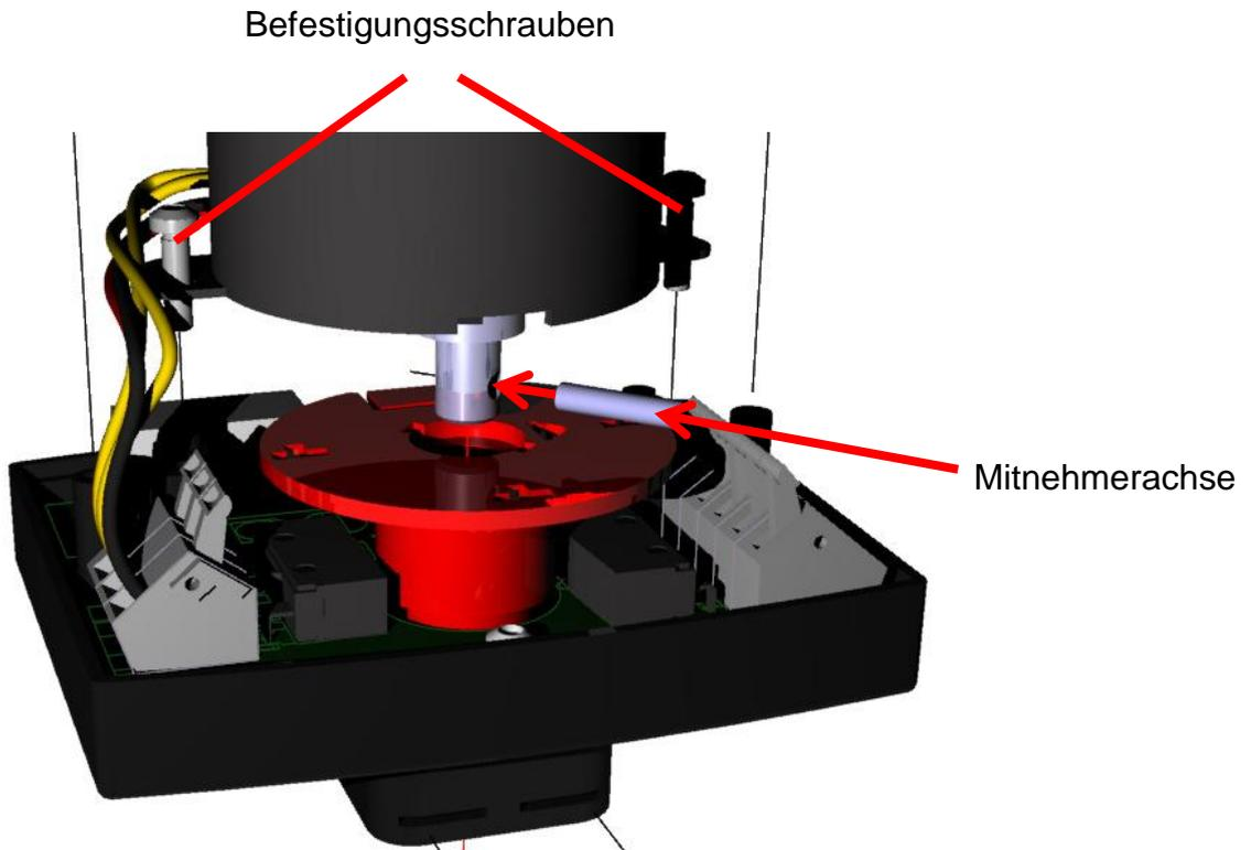
Der Motor ist bereits werksseitig an die Motorklemmen angeklemt. Diese Anschlüsse dürfen nicht vertauscht werden.
