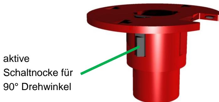
Wird die bereits ausgebrochene Schaltnocke nicht mehr benötigt, kann man diese um 180° verdreht in die Nut einschieben, damit diese den Endscharter nicht mehr schalten kann:
