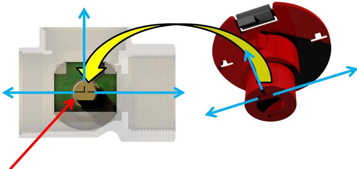
Die **Markierung** auf der Ventilachse zeigt die Stellung des Kugelventiles an.
