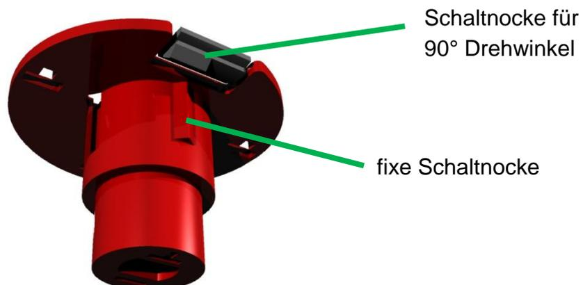
Wird ein Schaltwinkel von 90° gewünscht, so muss eine 2. Schaltnocke in die Welle eingesetzt werden. Dazu bricht man diese Schaltnocke, die in den Zeichnungen grau gekennzeichnet ist, aus der Scheibe heraus und schiebt diese in die dafür vorgesehenen Nut.
