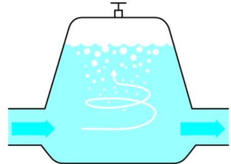
Lufttopf für waagerechten Einbau
