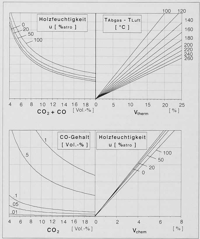
Bild 2. Nomogramm zur Bestimmung des feuerungstechnischen Wirkungsgrads, wobei  $\eta f = 100 - V_{therm} - V_{chem}$  [ % ] = feuerungstechnischer Wirkungsgrad;  $V_{therm}$  = thermische Abgasverluste;  $V_{chem}$  = chemische Abgasverluste
