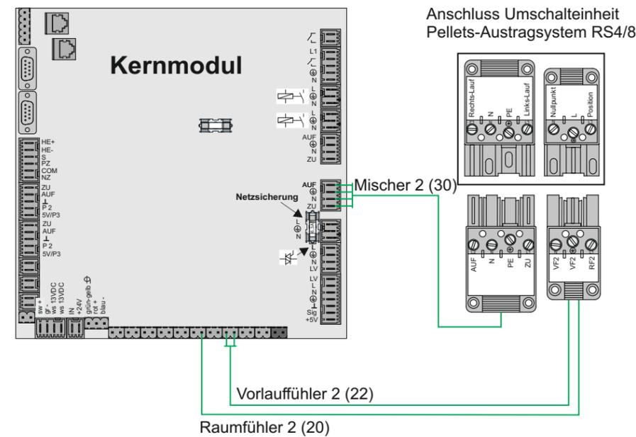
\* Rücklauffühler bei Hackgutkessel T4 bereits vorverkabelt!
