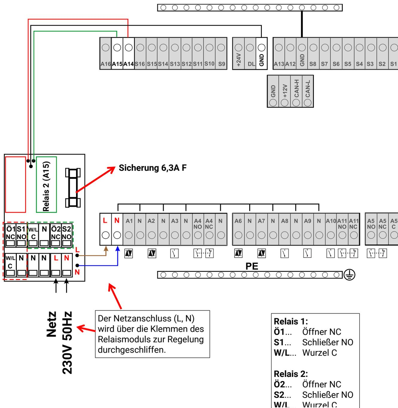
Das Relaismodul kann an zwei beliebige Ausgänge zwischen A12 und A16 angeschlossen werden, wenn diese als Schaltausgang parametrierbar sind.
