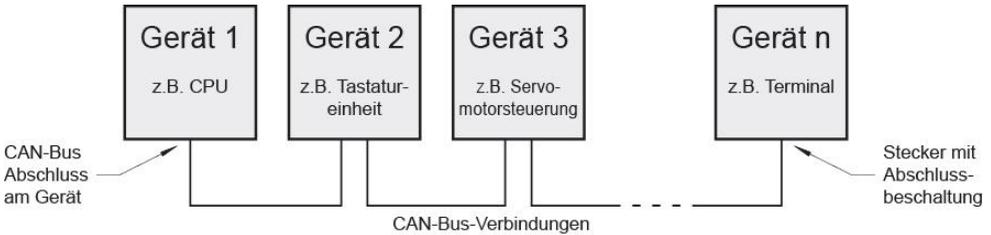
**Der Leitungsabschluss erfolgt durch einen intern bestückten 120R Widerstand zwischen den Leitungen CAN A (LOW) und CAN B (HIGH).**
