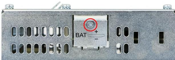
**Es ist darauf zu achten, dass beim Batterietausch kein Kurzschluss verursacht wird, da es sonst zu einem Defekt des Gerätes kommen kann!**
