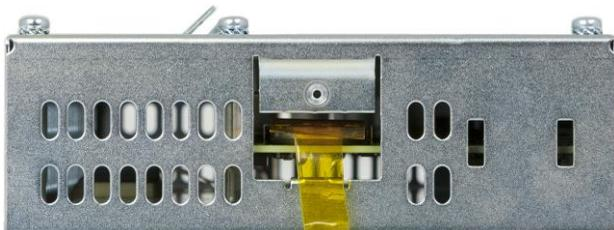
4. Neue Batterie in richtiger Polung einsetzen (Plus-Pol Richtung Terminal-Rückseite) und Batteriedeckel anschrauben.
