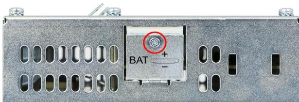
4. Batterie mit Hilfe der Lasche aus dem Batteriehalter entnehmen.
