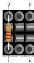
**Der Leitungsabschluss erfolgt ab HW-Version 1.10 durch einen auf dem Stecker X5 bestückten 120R Widerstand zwischen den Leitungen RS485/Modbus-A und RS485/Modbus-B.**
