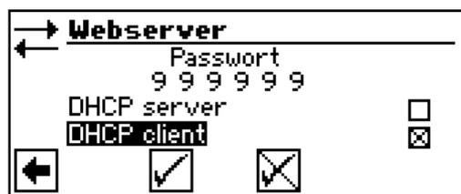
Der PC muss dann ebenfalls als DHCP-Client konfiguriert werden. PC und Wärmepumpenregelung bekommen dann von einem im Netzwerk vorhandenen DHCP-Server die IP-Adressen zugewiesen( z.B. einem Router).
