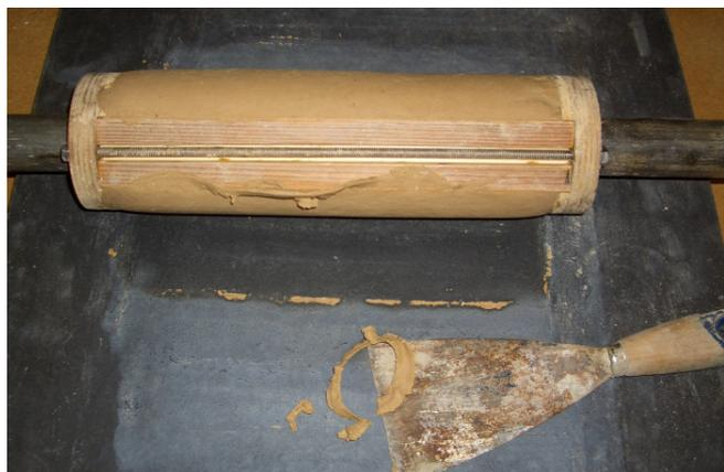
Fertig. Jetzt das Wasserleitungsrohr vorsichtig rausziehen und die Form senkrecht aufhängen. Der Lehmrohling schrumpft die nächsten Tage um 6-8mm und versucht sich etwas nach außen zu wölben. Das kann man mit einer Bandage verhindern.
