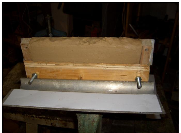
Will man einen strukturierten Düsenpalt, fertigt man sich ein Mininudelholz an. Es soll beidseitig Anlaufbunde haben und in der Profiltiefe auf etwa 50% des Zahnprofils ausgedreht sein. Hier ist Experiment und Anpassarbeit angesagt.
