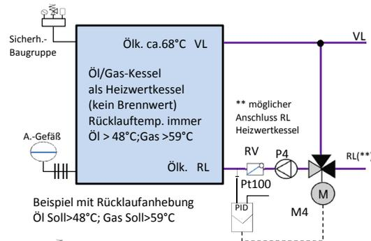
In der obigen Hydraulikschaltung ist mit niedrigen Rücklauftemperaturen zu rechnen.
