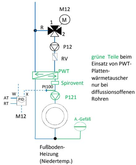
Zusätzliche Niedertemperaturheizung (FBH) vorrangig beheizt durch Rücklauf einer vorhandenen Hochtemperaturheizung (Radiatoren) zur Absenkung der Rücklauftemperatur z.B bei Brennwertkesseln und zur Erhöhung der nutzbaren Speicherenergie. Der Einsatz eines Plattenwärmetauschers mit A.-Gefäß und Pumpe P121 ist bei Einsatz älterer Kunststoffrohre vorzusehen. Wird bei Verbundrohren nicht mehr benötigt. Änderung rechts ist GRÜN eingezeichnet und muß VOR dem zentralen Rücklauf erfolgen.
