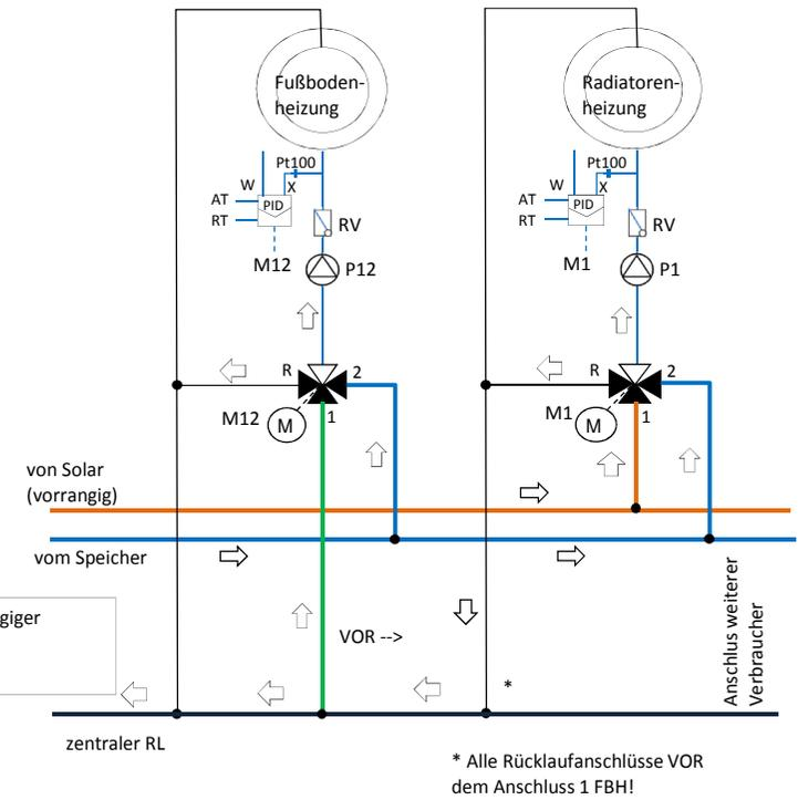
Verschaltung zum Erreichen möglichst niedriger Rücklauftemperaturen zum Speicher ohne solare Wärme
