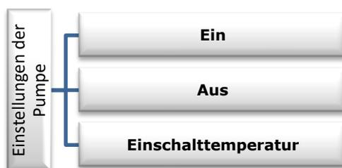
Damit sich die Pumpe einschaltet, müssen Sie die Option EIN auswählen und als nächstes die bevorzugte (am Kessel gemessene) Einschalttemperatur der Pumpe festlegen.
