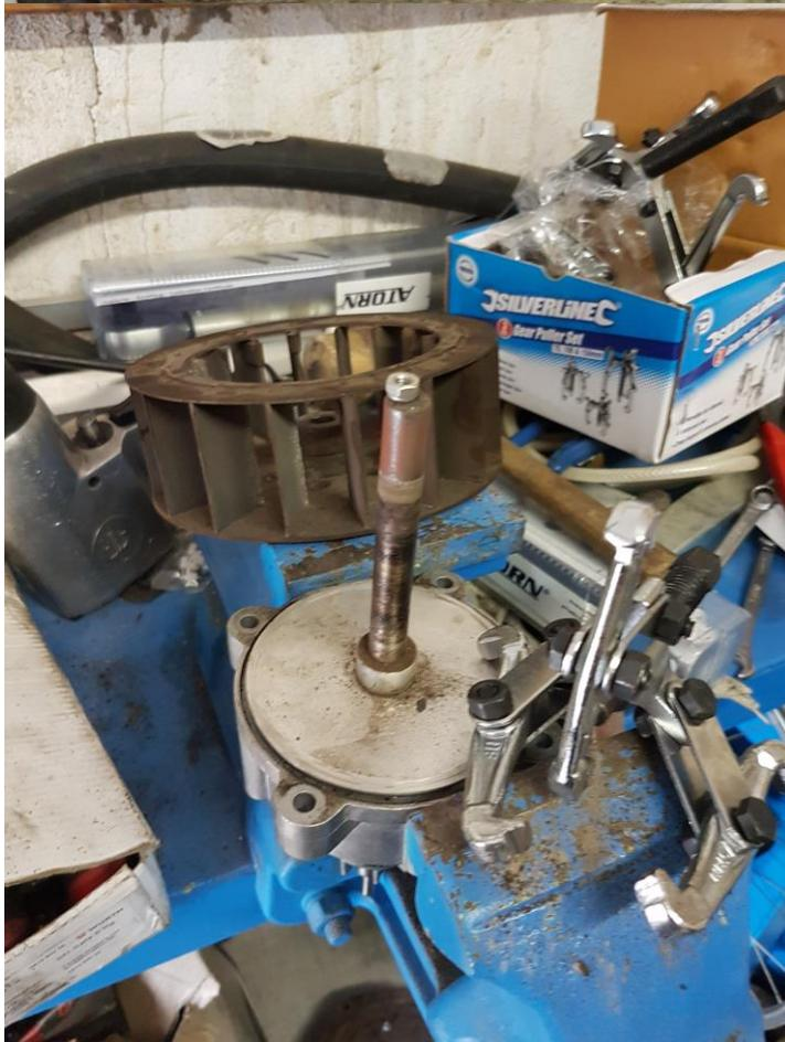
Bei mir haben die Abzieher leider nicht richtig gepasst was wohl auf die Art des Abziehers ankommt, also bitte testen. Die Inbusschraube am Lüfterrad lösen, und das Lüfterrad abziehen. Wie ihr unten seht muss am Abzieher unten etwas abgeschliffen werden (siehe nächstes Bild).
