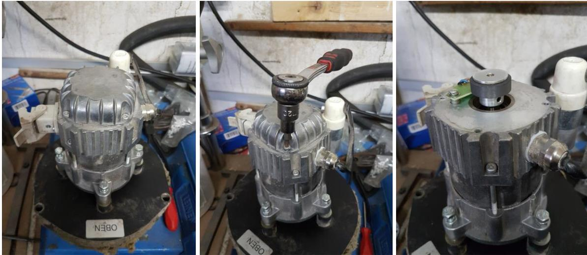
Danach das Rad mit dem Magneten (Drehzahlgeber) entfernen.
