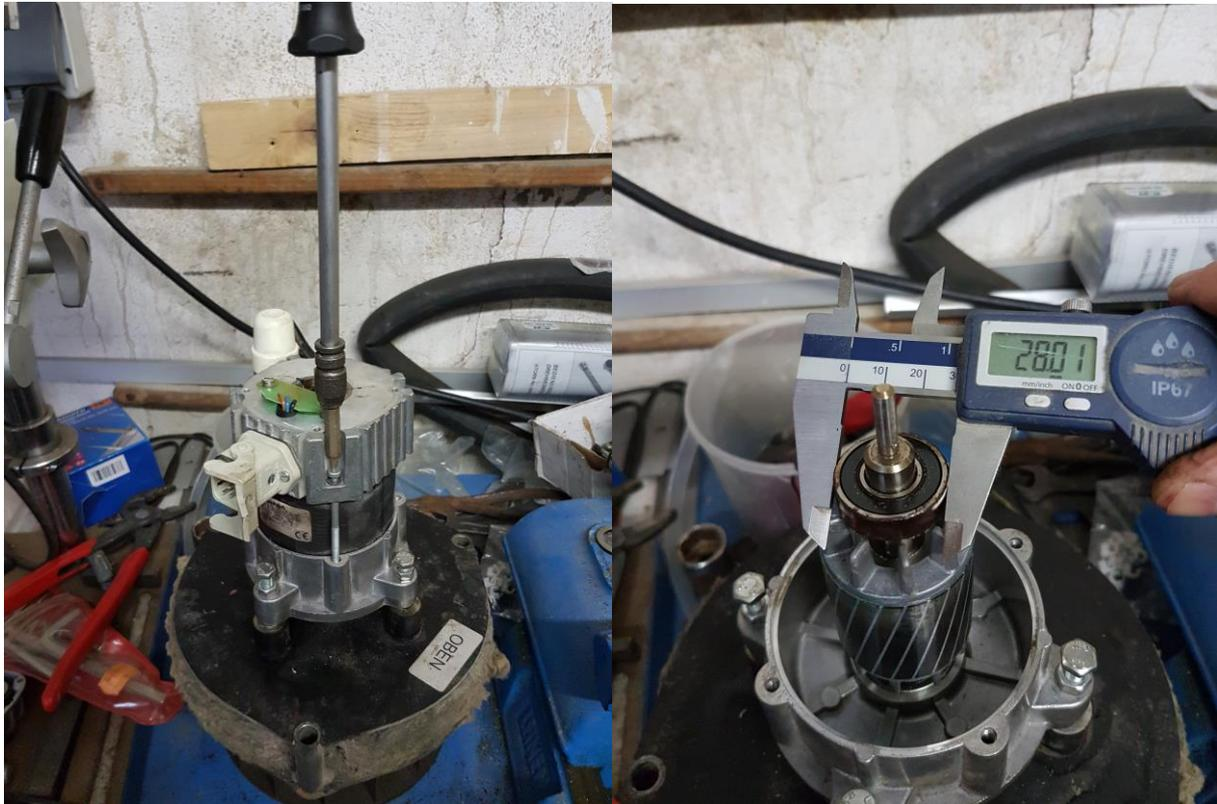
Anschliessend habe ich das gehäuse umgedreht, die Isolierung und die Staubschutzscheibe entfernt, und die Welle mit einem Holzhammer nach unten rausgedrückt.
