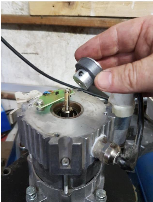
Anschliessend habe ich mit einem langen Bit die Schrauben die den Motor zusammen halten gelöst und anschliessend den Stator mit der restlichen Elektrik abgenommen.
