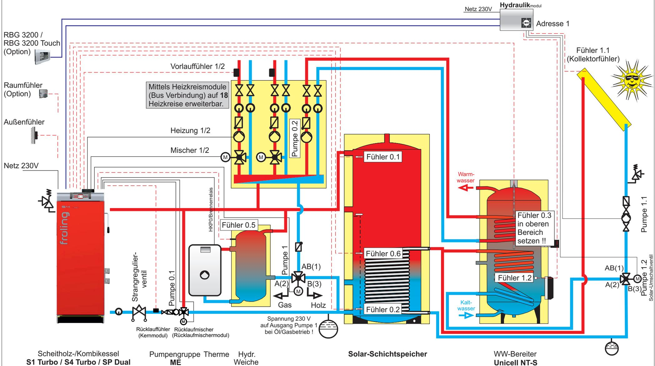
**Hinweis:** Im Menü SOLAR bei Einstellpunkt SERVICE den Parameter SOLAR SYSTEM auf "3", WELCHER FÜHLER WIRD FÜR DEN BOILER UNTEN VERWENDET auf "1.2" und WELCHER FÜHLER WIRD FÜR DIE PUFFERREFERENZ VERWENDET auf "0.6" stellen!
