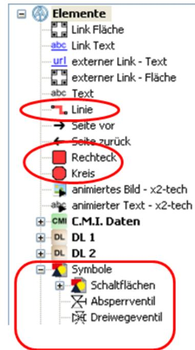
Einfache Hydraulikzeichnungen können mit Hilfe einer Linienfunktion und von Symbolen aus dem Auswahlbaum im TA-Designer gezeichnet werden. Diese Zeichnung kann durch weitere Grafiken oder Bilder ergänzt werden.
