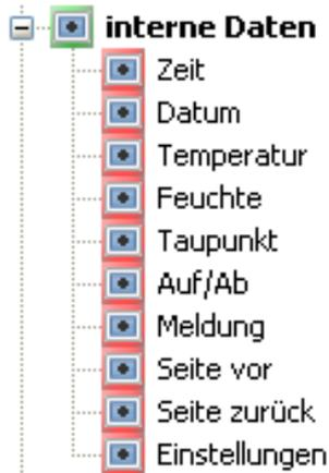
Aus dem Bereich „**interne Daten**“ des Suchbaums können die **Uhrzeit** und das **Datum** in die Grafik eingefügt werden. Diese Werte werden vom CAN-Busgerät mit der Knotennummer 1 übernommen und sind **nicht** veränderbar. Sollen Uhrzeit und/oder Datum veränderbar sein, dann müssen diese Werte aus den Funktionsdaten der UVR1611 oder UVR16x2 übernommen werden (Siehe Kapitel "[Datum / Uhrzeit](#)").
