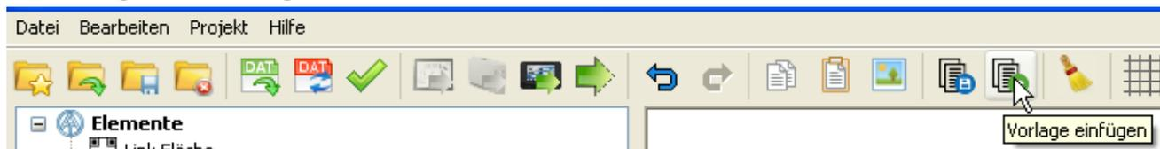
In ein bereits angelegtes Projekt kann eine gespeicherte Vorlage durch Anklicken des Symbols **"Vorlage einfügen"** geladen werden.
