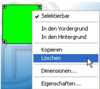
Das Löschen eines Objektes kann auch durch **Markieren** und Betätigen der „**Entf**“-Taste des PC erfolgen.
