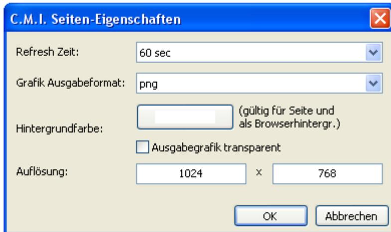
**Refresh Zeit:** Einstellungen des Zeitintervalls für die Aktualisierung der aktuellen Werte (nie, oder von 30 Sekunden bis 60 Minuten einstellbar). Eine sofortige Aktualisierung ist im Onlineschema durch Drücken der F5-Taste am PC möglich.
