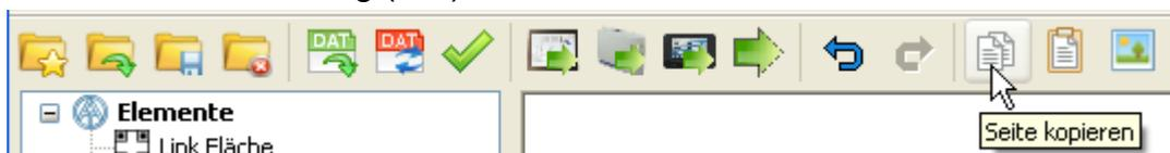
**3.** Einfügen durch Klick auf das Symbol „Seite einfügen“ in der Symbolleiste oder mit der Tastenkombination Strg (Ctrl) + v.
