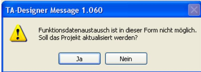
Wurde die Abfrage mit "ja" beantwortet und sind im Projekt Funktionsdaten mit identischen Knotennummern vorhanden, so muss die Aktualisierung abgebrochen werden:
