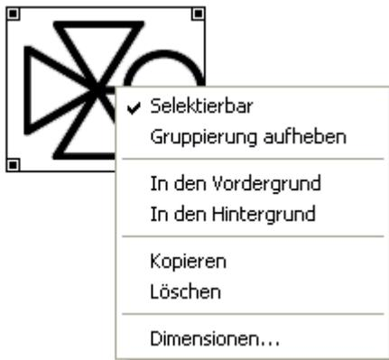
Durch "**In den Vordergrund**" oder "**In den Hintergrund**" oder durch die Tasten **b** bzw. **f** wird die markierte Gruppe in den Hintergrund bzw. in den Vordergrund gesetzt.
