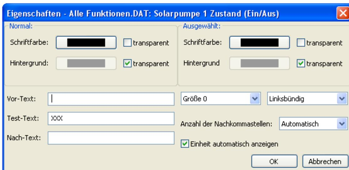
Im Bereich „**Normal**“ werden die Eigenschaften des Wertes eingestellt, wenn er im **Normalzustand** am Touchscreen angezeigt wird. Im Fall des Zeitprogrammes (Wochentagszuordnung) gelten diese Eigenschaften für die Anzeige der **zugeordneten Tage**.
