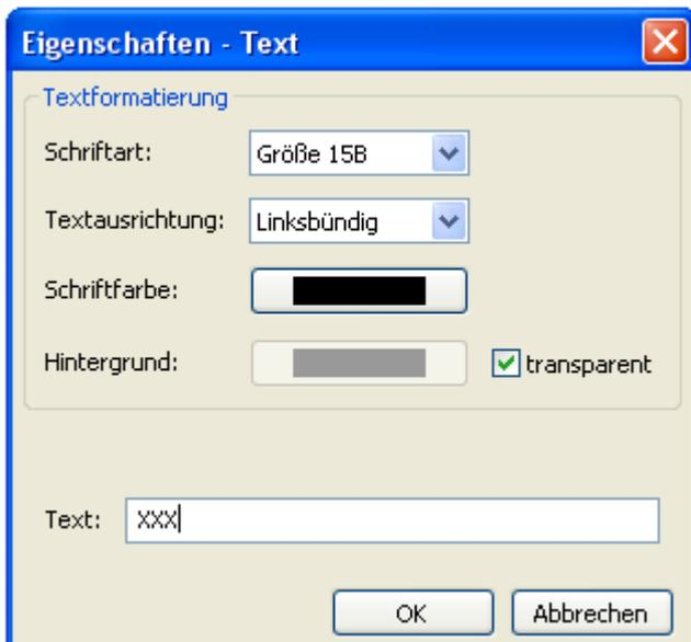
Es stehen 6 Schriftarten zur Verfügung, die sich in Schriftgröße und Schriftschnitt unterscheiden. Außerdem steht zur besseren Positionierung noch zur Auswahl, ob die Anzeige **linksbündig**, **rechtsbündig** oder **zentriert** positioniert werden soll. Durch Anklicken der Schrift- bzw. Hintergrundfarbe erscheint ein Auswahlfeld, in dem die gewünschte Farbe eingestellt werden kann.
