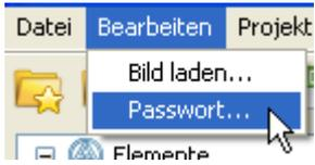
Im Untermenü „**Bearbeiten/Passwort...**“ kann ein Passwort für die gerade angezeigte Seite festgelegt werden. Diese Seite kann dann am Touchscreen nur durch Eingabe des Passwortes aufgerufen werden. Für die erste Startseite ist das allerdings nicht sinnvoll. Die Vergabelogik von Passwörtern sollte gut überlegt werden, da Passwörter das schnelle Aufsuchen von Submenüs erschweren.
