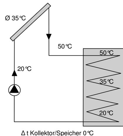
**Mittlere Kollektortemperatur = mittlere entsprechende Speichertemperatur**
