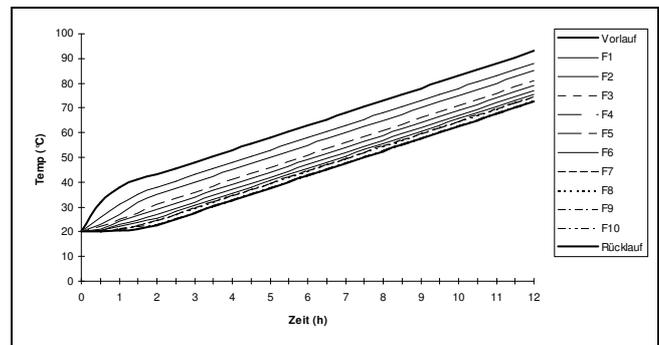
Die Speicherladung erfolgt konstant mit 10 kW bei einer Wärmeträgermenge von 500 l/h, was einem  $\Delta T$  des Sonnenkreises von 17°C entspricht.
