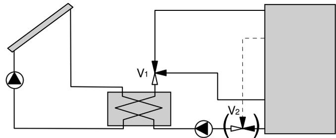
Zur Vermeidung von grossen Minderleistungen müssen beim externen Wärmetauscher die beiden Wassermengen so abgestimmt werden, dass auf beiden Seiten (primär / sekundär) die gleiche Temperaturdifferenz entsteht. Der richtig angeordnete integrierte Wärmetauscher stimmt sich selber ab und bringt die Wärme automatisch dorthin, wo sie hingehört.
