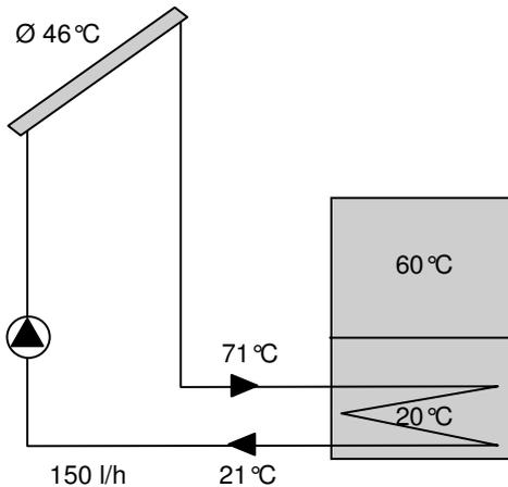
Wird im vorangehenden Beispiel als Folge der Fehleinschätzungen die Wärmeträgermenge stark reduziert, steigt die mittlere Kollektortemperatur beträchtlich an, aber es wird trotzdem nur Wasser von 20°C aufgewärmt. Die Heizleistung sinkt, weil das Produkt Wärmeträgermenge multipliziert mit der Temperaturdifferenz kleiner ist.
