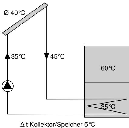
Bei einer High-Flow Anlage sind zwei Speicherzonen vorhanden. Eine Vorwärmzone und das Bereitschaftsvolumen. Die Arbeitstemperatur steigt bei Sonnenschein kontinuierlich an. Im Bereich des Wärmetauschers entsteht kaum eine Schichtung.
