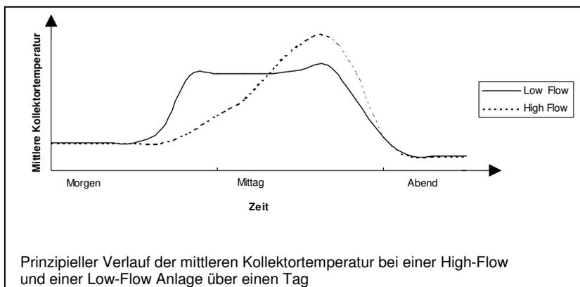
Die Low-Flow Technik ist vor allem für Anlagen geeignet, bei denen regelmässig eine relativ grosse Temperaturdifferenz überwunden werden muss. Also zum Beispiel Anlagen für die Warmwasseraufbereitung mit mittlerem bis höherem Deckungsgrad, bei denen häufig Wasser von 10°C auf 60°C aufgeheizt wird. Nicht geeignet ist sie bei Anlagen zur Warmwasservorwärmung oder für reine Schwimmbadbeheizung. Das Low-Flow-Prinzip würde zu
