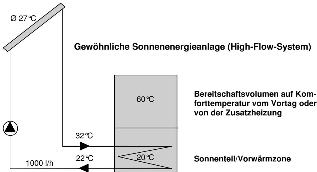
**Bei einer Temperaturdifferenz von 10 °C und einer Umwälzmenge von 1000 l (Wasser) pro Stunde, haben die Kollektoren eine Heizleistung von 11,6 kW.**
