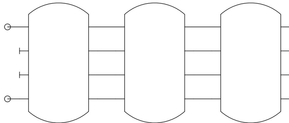
D) Parallelschaltung mit vollständiger Kopplung und Heißwasserreserve
