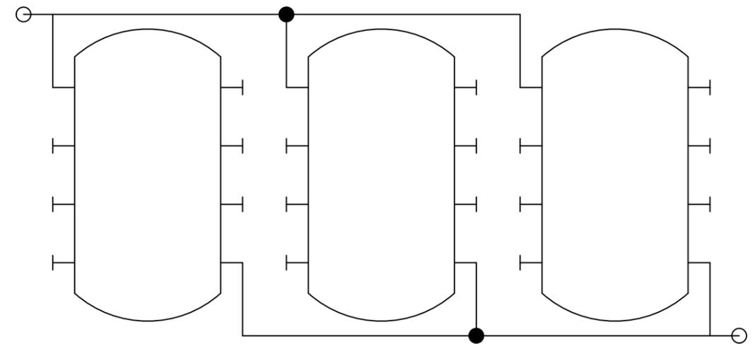
C) Parallelschaltung mit vollständiger Kopplung
