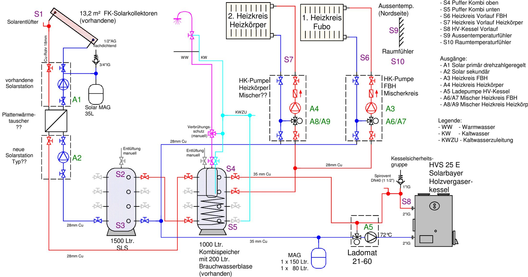
Die Solaranlage ist aktuell noch am Wärmetauscher des Kombispeichers angeschlossen. Dieser wird nach dem Umbau auf einen Plattenwärmetauscher stillgelegt. Später kommt evtl. noch eine Frischwasserstation anstatt der Brauchwasserblase hinzu. Das ganze soll mit der UVR1611 geregelt werden.
